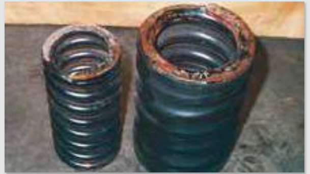
車輪用スプリングと防雪チューブの装着状況 (SPC)
