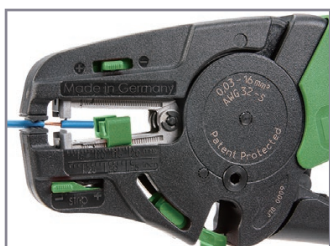
電線のむき出し
