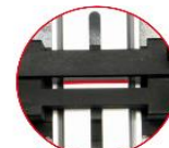
カット位置が見える DINレールの底辺裏面に描いたカット線を上から見てカットできます。
