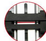
カット位置が見える DINレールの底辺裏面に描いたカット線を上から見てカットできます。
