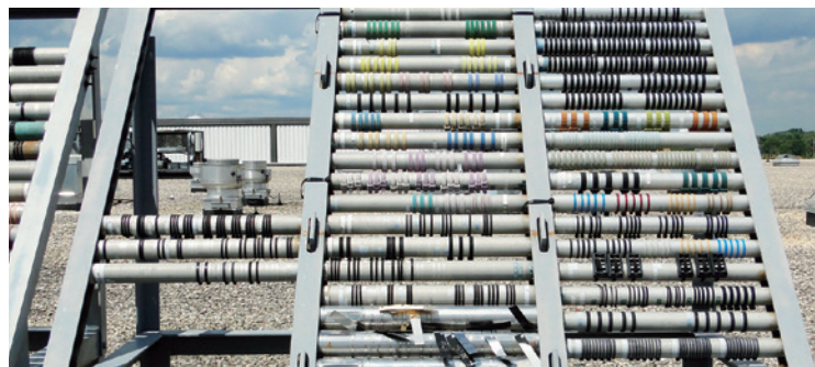
水分吸収率が低く風雨にさらされる屋外環境、湿気が多い悪環境において、劣化進行を大幅に抑制
